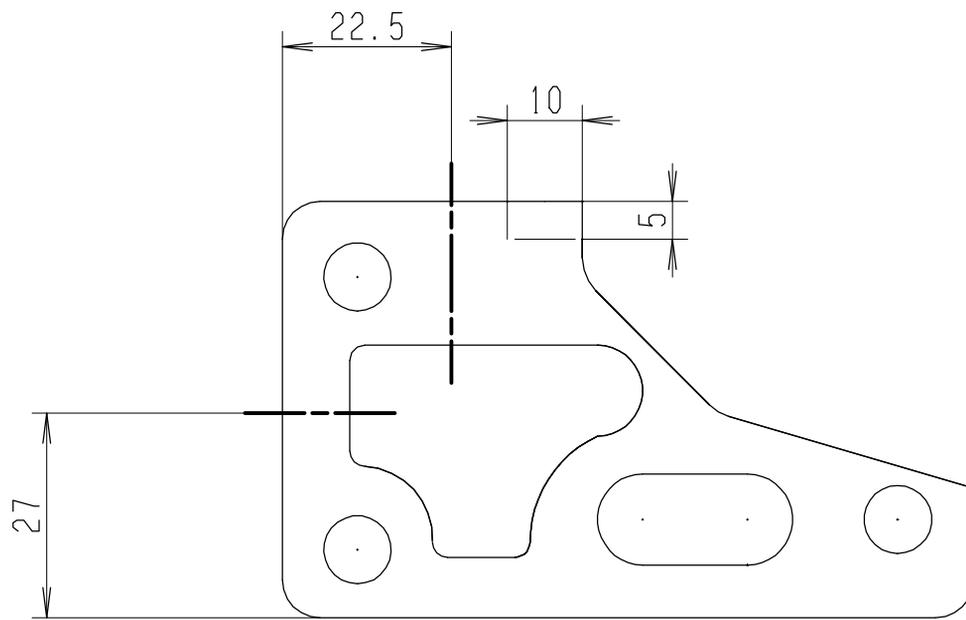
Aussparung für Lüftungsdeckel
